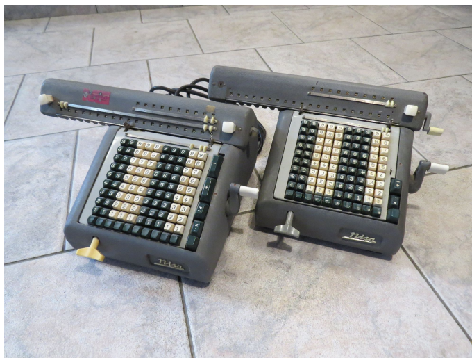
Obrázek 4.8: Srovnání mechanických kalkulátorů Nisa typ K1 a PK1.
