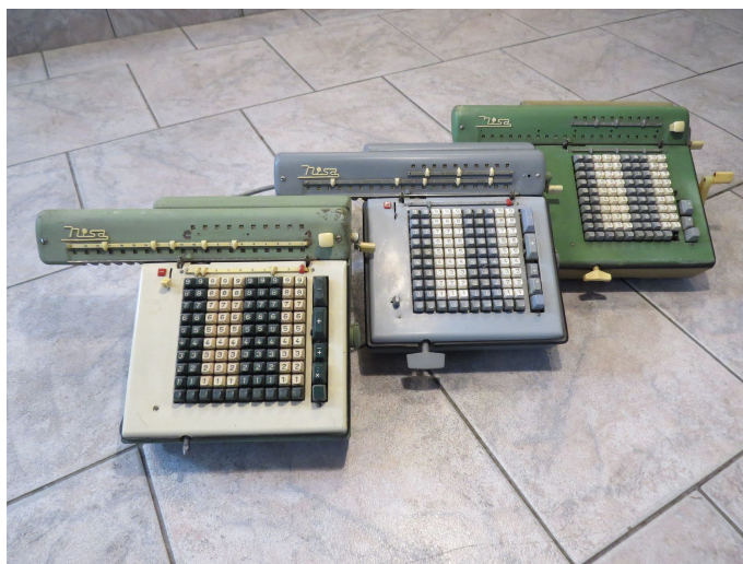
Obrázek 4.10: Srovnání mechanických kalkulátorů Nisa typ K1, resp. PK1, (pravděpodobně) novější varianty tohoto modelu.
