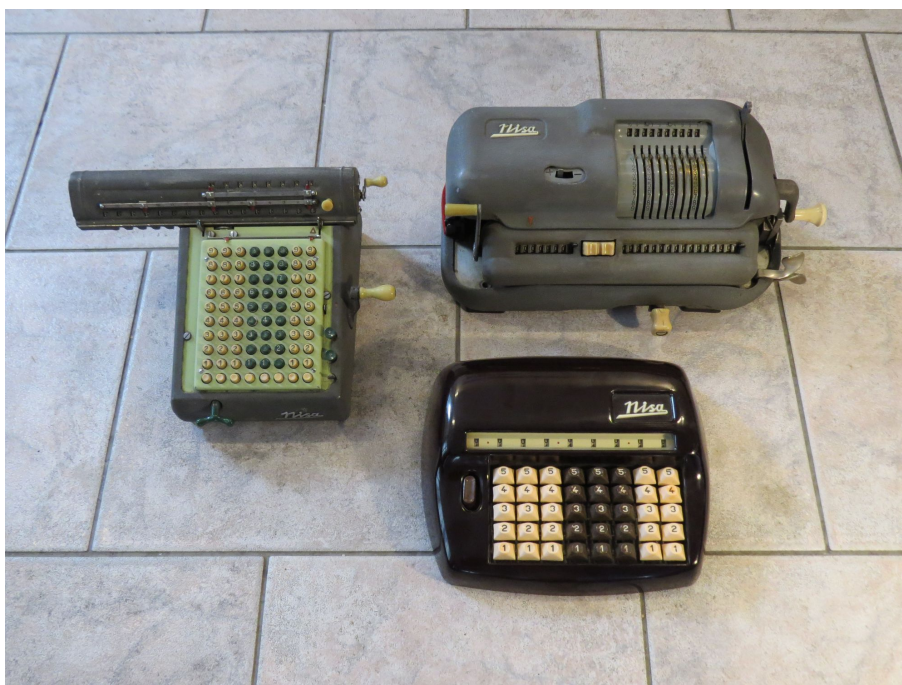
Obrázek 4.1: Srovnání tří různých technologií používaných při výrobě kalkulátorů Nisa.
