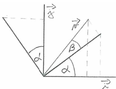
Na obázku jsou úsečkami vyznačené vektory  $\vec{i}$ ,  $\vec{j}$ . Jejich otočením o úhel  $\alpha$  vzniknou vektory  $\vec{i}'$ ,  $\vec{j}'$ . Z pravoúhlých trojúhelníků odvodíme lineární kombinace
