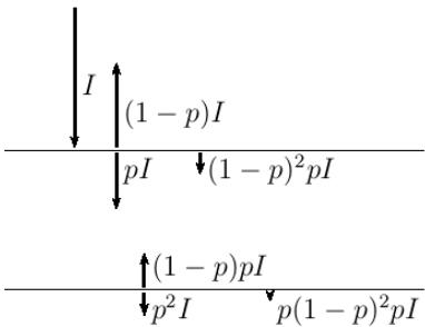
Na dalším obrázku jsou skla dvě a naším cílem je zjistit, kolik světla projde přes obě skla. Přímo, tj. bez odrazu zpět, projde  $p^2I$ . Zpět se od druhého skla odrazí  $(1-p)pI$  a po dalším odraze na horním skle  $(1-p)^2pI$ . Po tomto jednom zpětném odrazu pak přes dolní sklo projde  $(1-p)^2p^2I$ .
