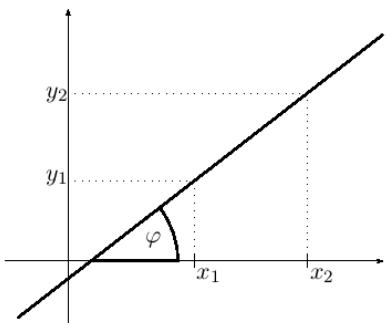
Protože přímka svírá s rovnoběžkami stejný úhel, dostáváme význam koeficientu u  $x$ : je roven tangentu úhlu, který svírá přímka s osou  $x$ .<sup>a</sup>
