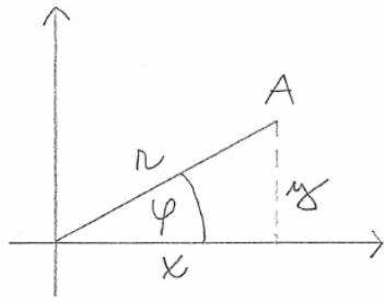
Polární souřadnice bodu  $A$  jsou definovány geometricky:  $r$  jako vzdálenost bodu  $A$  od počátku a  $\varphi$  jako úhel orientovaný od kladné poloosy  $x$  proti směru hodinových ručiček k průvodiči bodu  $A$ .
