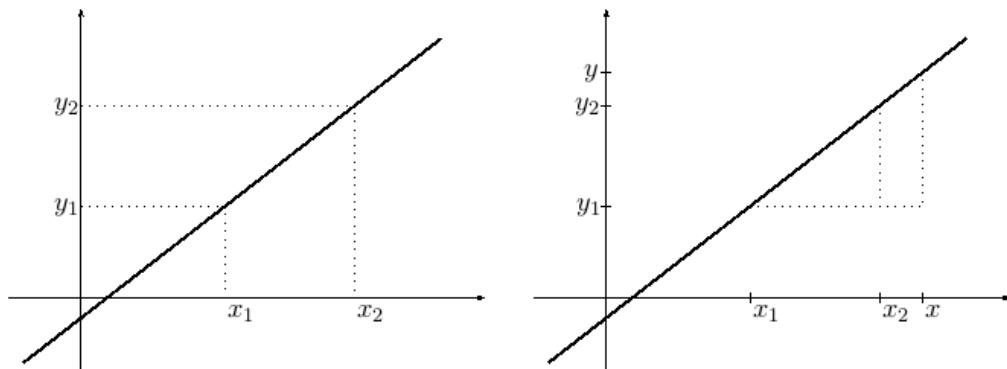
Vlevo jsou znázorněny takové dva body a vpravo jsme do obrázku přidali další bod přímky a tečkovaně jsme vyznačili dva podobné pravoúhlé trojúhelníky. Větší z nich má odvěsný délek  $x - x_1$ ,  $y - y_1$ , ten druhý délek  $x_2 - x_1$ ,  $y_2 - y_1$ .
