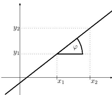
Na obrázku je vyznačen úhel  $\varphi$  v pravoúhlém trojúhelníku s tečkovanými odvěsnami a plnou přeponou. Ve vztahu (15.4) jsou v čitateli a jmenovateli velikosti odvěsen, od kud dostaneme
