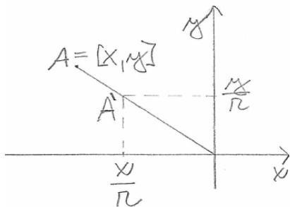
Na obrázku je kromě bodu  $A = [x, y]$  znázorněn bod  $A' = [x/r, y/r]$ , který leží na jednotkové kružnici. Odtud dostaneme  $x/r = \cos \varphi$ ,  $y/r = \sin \varphi$  a odtud platnost (20.1).
