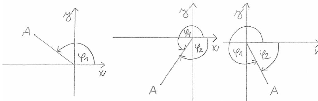
Souřadnice  $\varphi$  nabývá podle výše uvedené definice (úhel orientovaný od kladné poloosy  $x$  proti směru hodinových ručiček k průvodiči bodu  $A$ ) hodnot  $\varphi \in [0, 2\pi)$  – tomu odpovídají úhly  $\varphi_1$ . Ve výpočtech je možné použít úhel lišící se o celistvý násobek  $2\pi$ , například  $\varphi_1 - 2\pi$ , což je až na znaménko úhel  $\varphi_2$ . Záporné znaménko odpovídá opačné orientaci úhlu.
