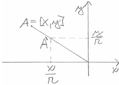
Na obrázku je kromě bodu  $A = [x, y]$  znázorněn bod  $A' = [x/r, y/r]$ , který leží na jednotkové kružnici. Odtud dostaneme  $x/r = \cos \varphi$ ,  $y/r = \sin \varphi$  a odtud platnost (19.1).
