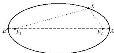
Elipsa je množina bodů v rovině, které mají součet vzdáleností od dvou daných bodů  $F_1, F_2$  roven danému číslu  $2a$ . Body  $F_1, F_2$  nazýváme ohnisky elipsy. Formálně zapsáno je elipsa množina
