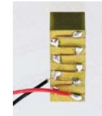
Vysoká blokovací síla (kN), malá výchylka ( \approx 1-10\mu\text{m} ) bez mechanického zesílení 21.10.2010 profesorská přednáška FP TUL 24
